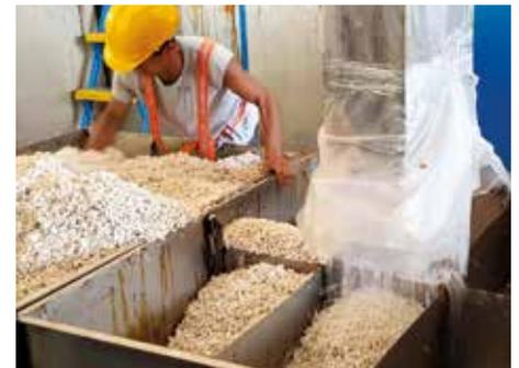
*Ein Stück TSR 20 Kautschuk nach dem Erhitzungsdurchlauf im Ofen (zwecks Konservierung), vor der Pressung, in der vorgeschriebenen Reinheit und Körnung.*
